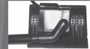
Pumpe in einer der Schalenfilterhälften legen
