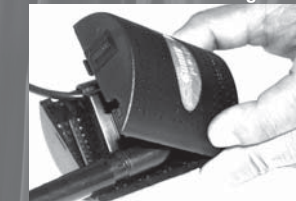
Legen Sie die andere Hälfte, von unten nach oben auf und pressen Sie beide Hälften zusammen
