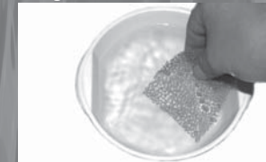
Reinigen Sie den Filter aus dem Gehäuse mit Wasser
